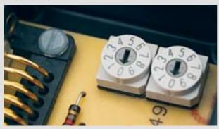
Codierschalter, induktive Bauelemente und Steckverbinder sind zentrale Komponten für die Industrieelektronik und den Steuerungsbau.
